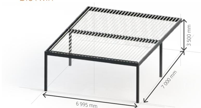
Au delà de 6000mm, un 3ème poteau est nécessaire à la jonction de la poutre transversale.
