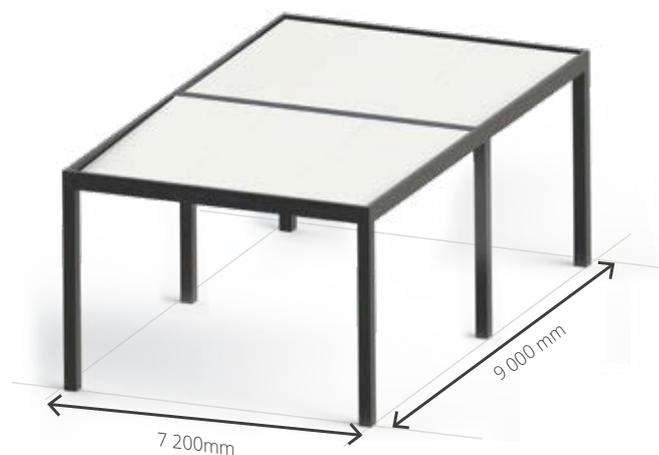
Au delà de 6000mm, un 3ème poteau est nécessaire à la jonction de la poutre transversale.
